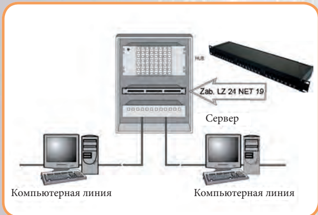
Рисунок 146 – Защита линии передачи данных (LAN) с помощью LZ 24 NET 19
