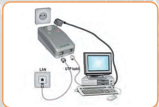
Рисунок 147 – Защита компьютера, питающей сети и линии передачи данных (LAN) с помощью универсального ограничителя C 200 NET
