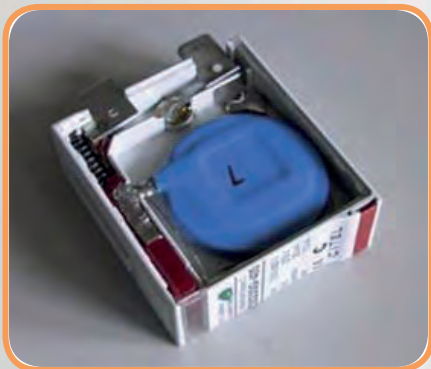
Рисунок 25 – Ограничитель перенапряжения с варистором и термической защитой
