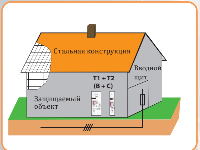
Рисунок 99 – Стальная конструкция в качестве внешней молниезащиты
