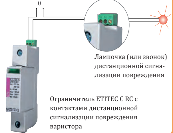
Рисунок 65 – Сигнализационная цепь ограничителя перенапряжения Типа 2
